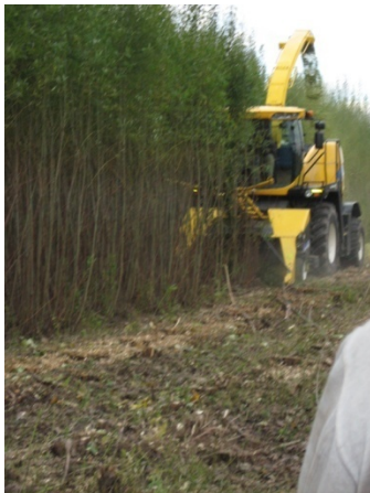
Figure 2. Récolteuse de fourrages New Holland 9060 fauchant un taillis de saule.
